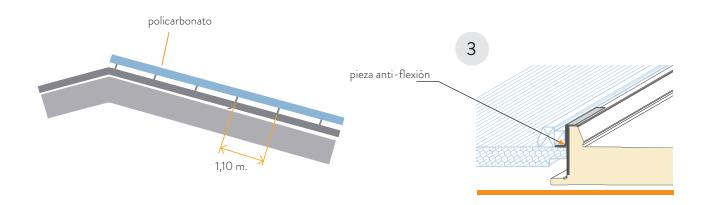
• Taladre las placas con agujeros, por lo menos, 3 mm más grandes que el cuerpo del tornillo. NO ATORNILLE con excesiva presión, para permitir el desplazamiento de la placa al dilatar. NO INSTALE las placas con tensiones inducidas que puedan volverlas quebradizas o causar micro-fisuras (fig. 4).
